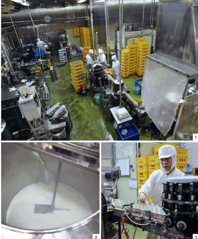
①工場では牛乳のほか、コーヒー牛乳やフルーツ牛乳なども生産している。すべて合わせて1日約4,000ℓが生産される ②生乳を専用のタンクに移して低温殺菌を行う。鮮度が重要なため、殺菌後は瞬時に冷却され、すぐに瓶やパックに注がれていく ③熟練スタッフの目視によって最終段階の検品が行われる
