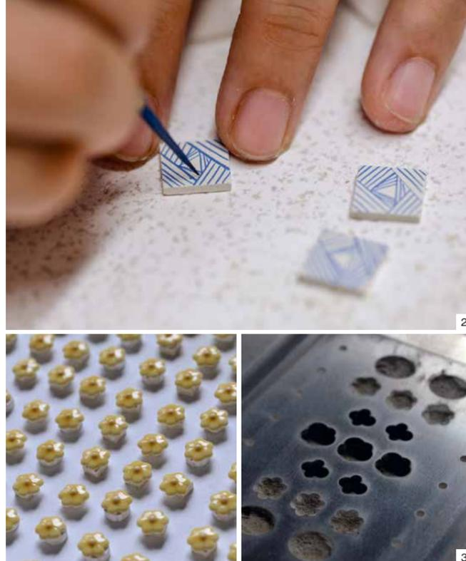
①成形の際に使用するプレス機。アクセサリーのほか、役物タイルの生地もここで成形される ②四角形の生地に、筆で一本ずつ線を引いて花びらを表現。1,250℃で焼成した後、中央に金彩を施し、800℃でさらに焼成すると、バラの花のピアスが完成する ③大量に生産しやすいタイルは、同じ形を配した金型が多いが、七窯社では一つの金型にさまざまな形が配されている特注品を使う
